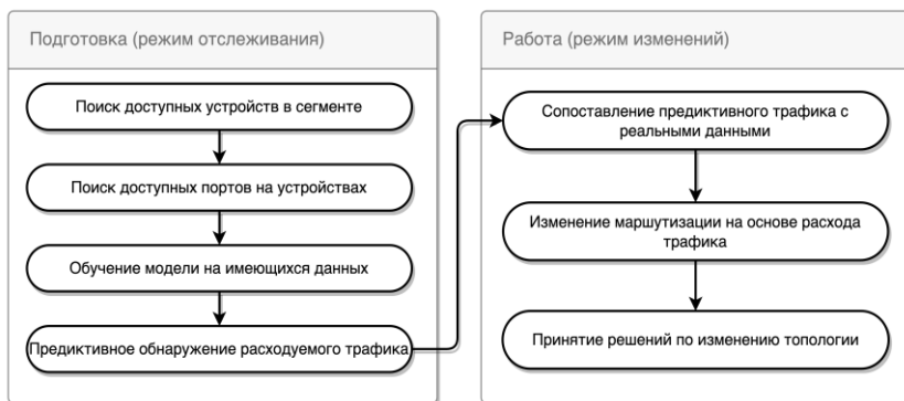
Рис.4. Схема адаптации топологии электроэнергетических комплексов
