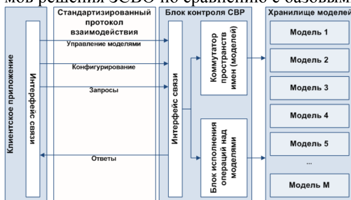
Рис. 2. Базовая архитектура СВР
