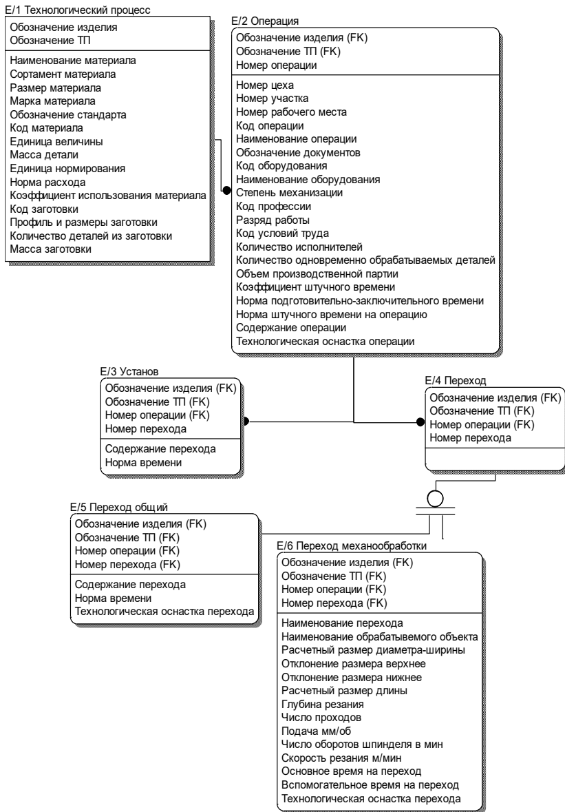
Рис 4 . Концептуальная модель данных ТП механической обработки
