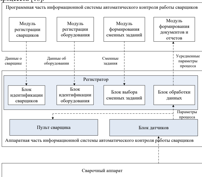
Рис. 1. Структурная схема концепции создания информационных систем контроля работы сварщиков
