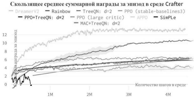
Рис. 7. Графики зависимости скользящего среднего суммарного вознаграждения за эпизод от количества шагов в среде Crafter для всех рассматриваемых алгоритмов с бюджетом взаимодействия со средой не более 4.5 млн шагов. Произведено усреднение кривых по трём запускам алгоритмов. Затенение показывает минимальное и максимальное значение в группе запусков
